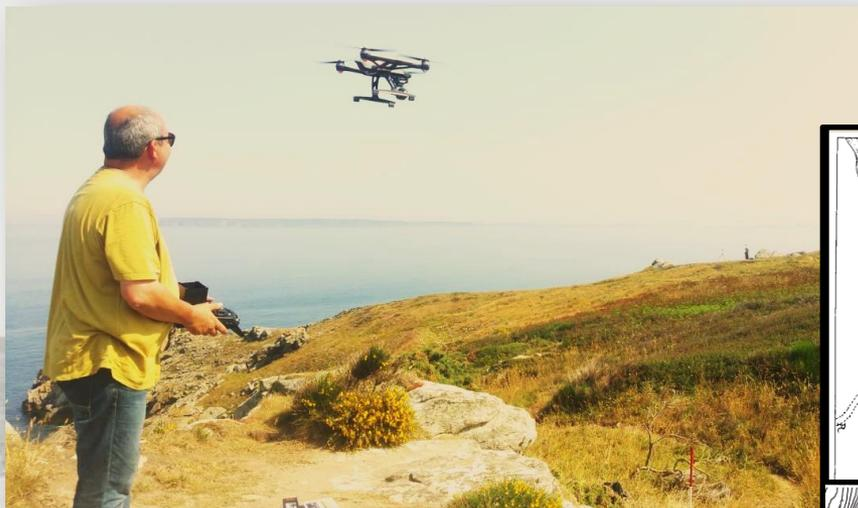
Utilisation d'un drone afin d'obtenir un relevé photogrammétrique du site
